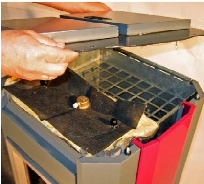
Funktionsplatte mit der Serviceklappe und dem Silodeckel in einem Vorgang vorsichtig abnehmen, und so ablegen, dass keine Teile beschädigt werden.
