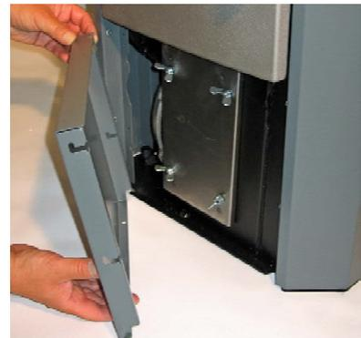
Mit einem Staubsauger die Ablagerungen im Innenbereich des Gehäuses und auf dem Flügelrad des Abgasventilators absaugen.
